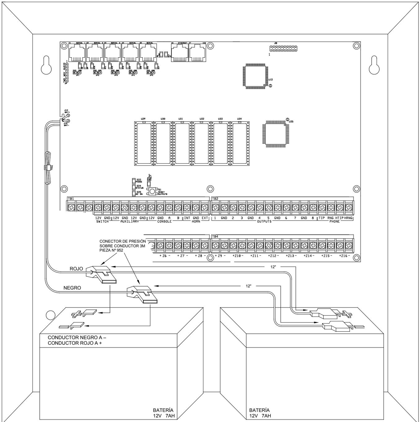
FIGURA 17 – CONEXIONES PARA 24 HORAS DE ESPERA
