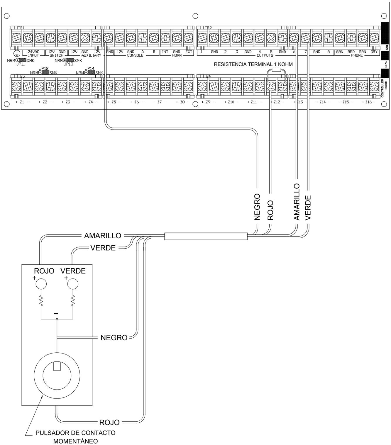
**FIGURA 9 - CONEXIONES DEL INTERRUPTOR CON LLAVE REMOTO**
