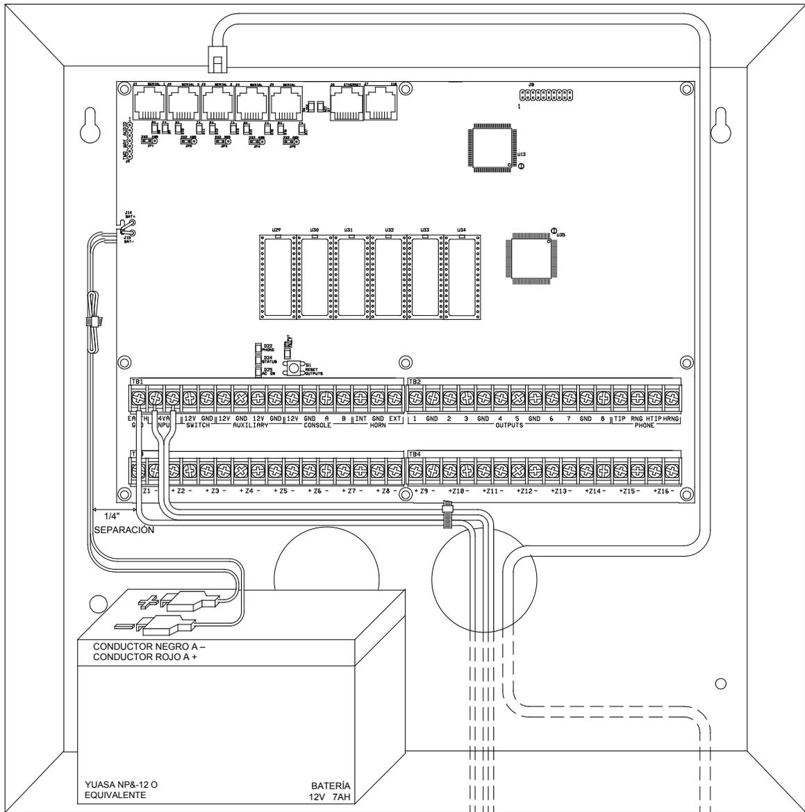
LA BATERIA NO TIENE LÍMITE DE POTENCIA. EL CABLEADO DE LA BATERIA DEBEN SEPARARSE DE CUALQUIER OTRO CABLEADO CON LÍMITE DE POTENCIA/CLASE II DEL GABINETE AL MENOS EN 1/4"
