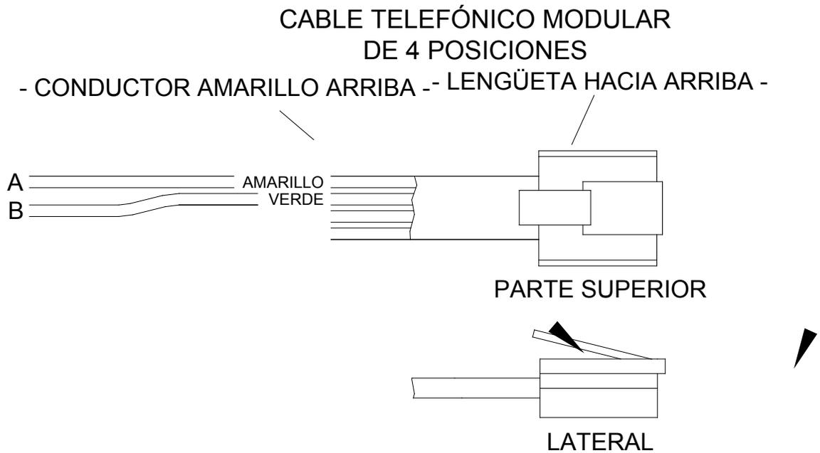
**FIGURA 14- CONEXIONES RS-485**
