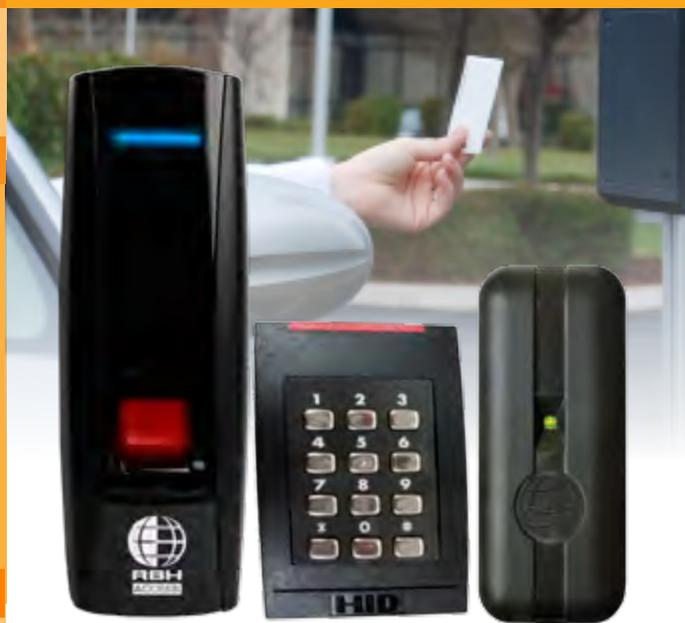
La arquitectura empleada en el UNC100 permite mediante el uso de una interfaz Wiegand el uso de cualquier tipo de lector o tecnología de proximidad, tarjeta inteligente o biométrica.
